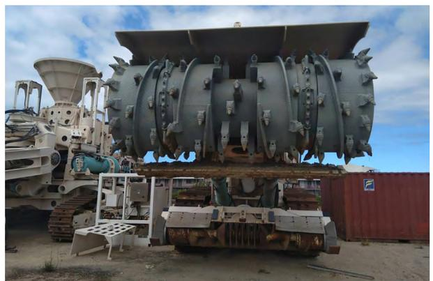
**Maschinen wie diese wurden von Soil Machine Dynamics Ltd (SMD) für Nautilus Minerals Inc. und deren Solwara 1-Projekt in Papua-Neuguinea entwickelt. Ähnliche Maschinen könnten auch im norwegischen Tiefseebergbau zum Einsatz kommen. <sup>6</sup> Das Maschinenkonzept von Green Minerals AS aus 2024 ähnelt dem von Nautilus Minerals Inc. <sup>7,8</sup>**
